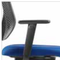
4F-Armlehnen, Auflagen PU soft, höhen- (10 cm), breiten- (5 cm) und tiefenverstellbar (4 cm), beidseitig um 30° schwenkbar; Armlehnen-träger Kunststoff schwarz, Hülse schwarz 4F armrests, PU soft armpads, height- (10 cm), width- (5 cm) and depth-adjustable (4 cm), 30° swivel range on both sides; black plastic armrest posts, black casing. (A408KGS)
